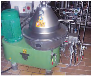
그림 6-73 대형 주류산업체에서 사용하는 세퍼레이터 출처: 오비맥주(주)
