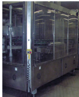
그림 6-82 무균실에 설치된 병입기 출처: In Bev Brewery
