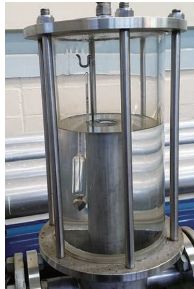
【그림 2-4】 유출액 사이트 글라스 (Sight Glass)와 비중계(Hydrometer)
