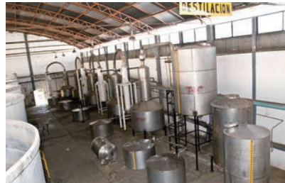
【그림 8-18】 스테인리스 증류 장치
