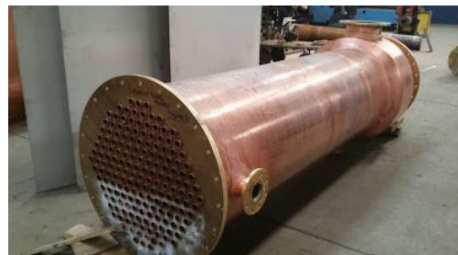
【그림 2-28】 셸-튜브형 응축기(Shell and Tube Condenser)
