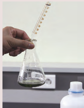
그림 3-43 채취한 시료 10 mL에 지시약을 넣고 0.1 N 수산화나트륨으로 적정
