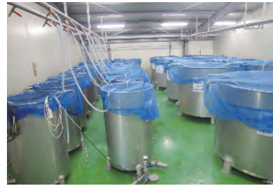
그림 3-37 1단 담금 탱크와 본담금(2단 담금 이상) 탱크를 분리해 운영하는 사례
