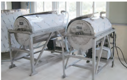
그림 3-46 드림 방식 탁주 제성기가 2대 연속 설치된 2단 제성기와 드림체
