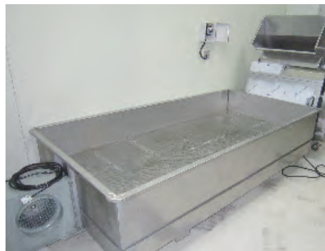
그림 3-17 강제 송풍기가 설치된 고두밥 냉각기
